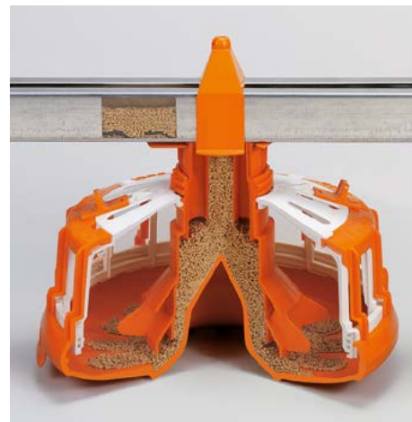
Распределение корма в кормушке FluxxBreeder
