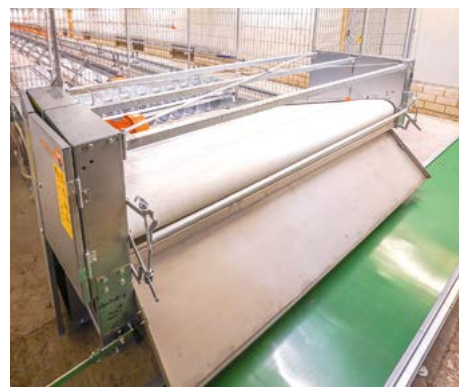
Помет поступает на поперечный транспортер на уровне пола корпуса
