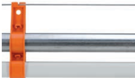
Rura poidła z rurą okrągłą i pojedynczą linką zapobiegającą siadaniu
