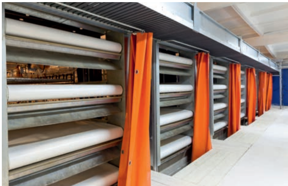
Les racleurs à fientes en acier spécial garantissent un nettoyage en profondeur des tapis à fientes
