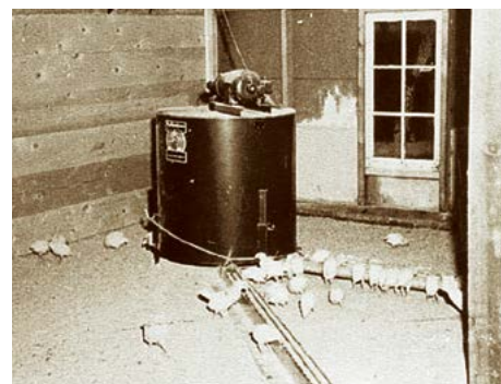
Le premier système d'alimentation à chaîne aux États-Unis en 1938
