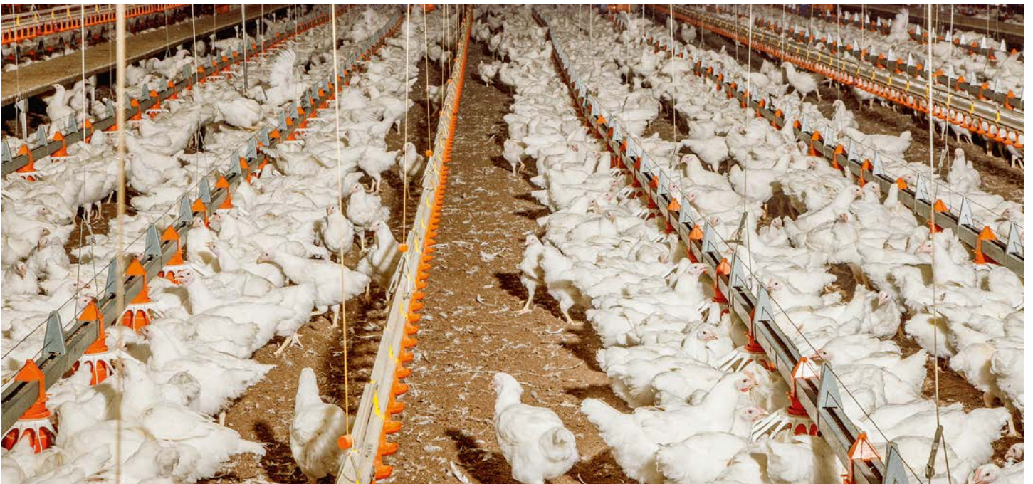
ReproMatic avec FluxxBreeder – une combinaison de l'alimentation à chaîne et à plateaux qui effectue également une distribution d'aliments rapide et uniforme
