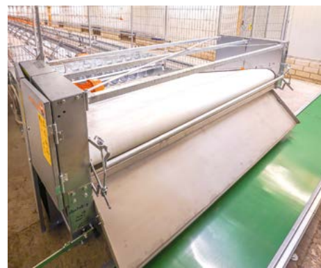
Les fientes tombent sur une bande transversale au niveau du sol
