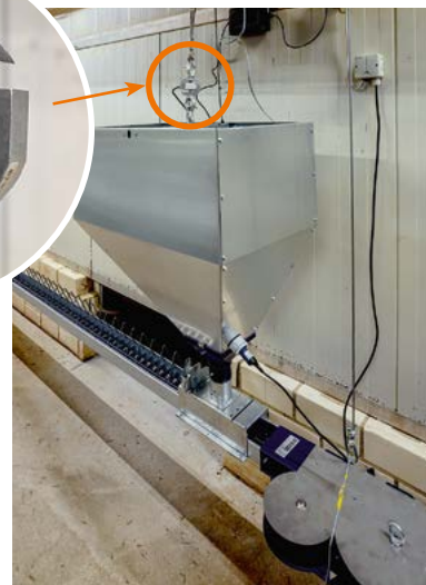
Pesage précis des aliments pour MaleChain
