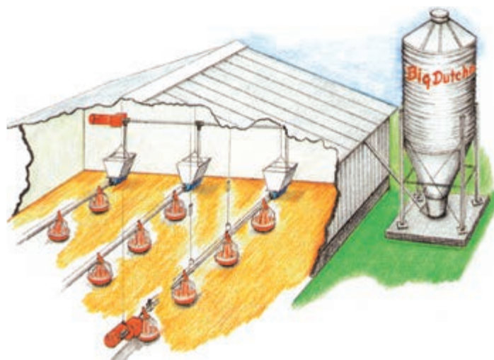
Representación esquemática de una nave con líneas AugerMatic
