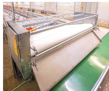
El estiércol se deposita sobre una cinta transversal a nivel de suelo
