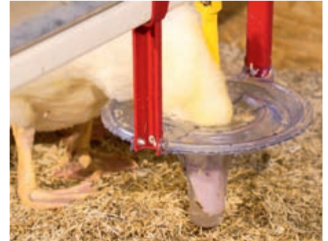
La copa con forma de embudo se presenta aquí como prototipo transparente, que muestra de forma clara cómo se sumerge el pico (limpieza de los agujeros de la nariz) y la cabeza (limpieza de los ojos).
