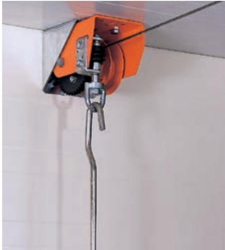
Torno para el montaje en techo o en frontón
