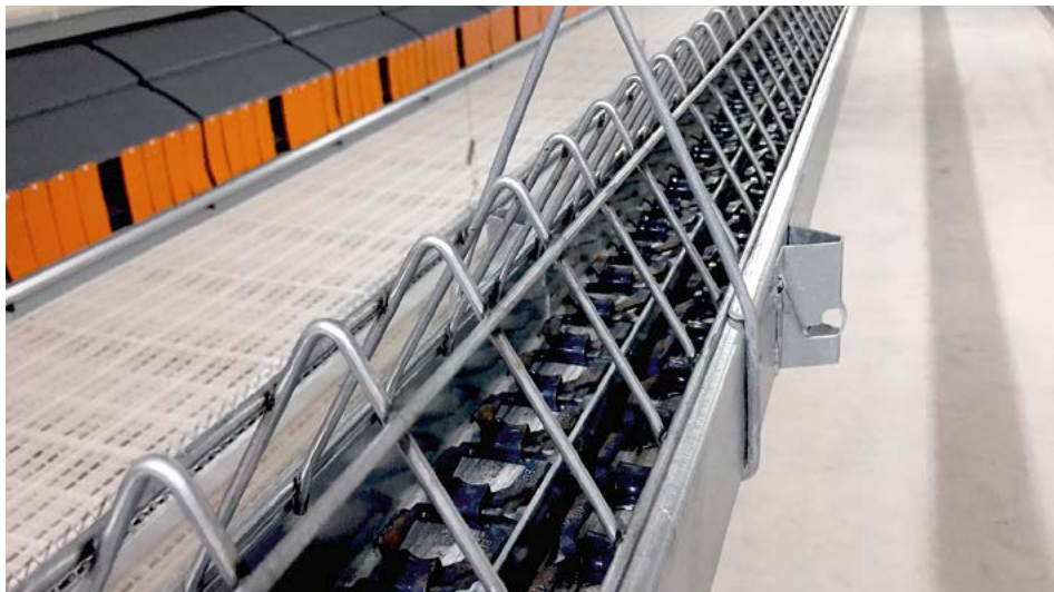
FeMaleChain – das neue Fütterungssystem für die Hennen
