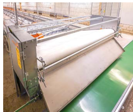
Der Kot wird auf ein ebenerdiges Kotquerband übergeben
