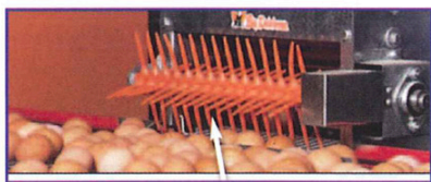
Рис. 2. Переход яйца на поперечный транспортер при помощи колеса с пальчиковой передачей
