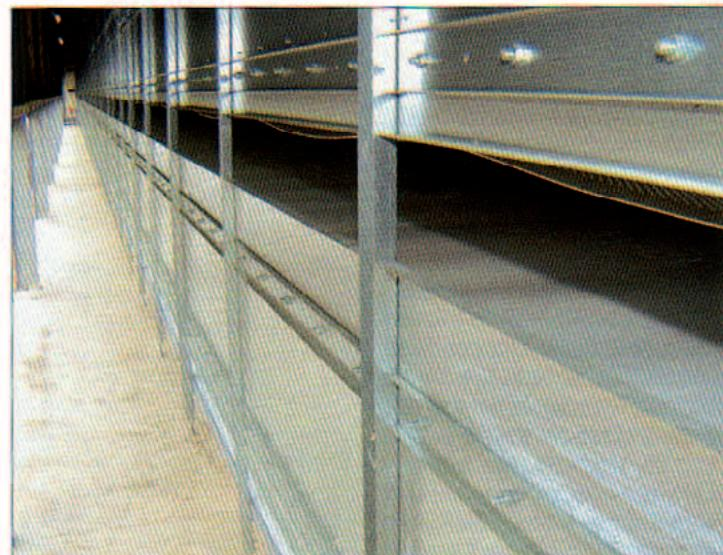
▲ La batterie de séchage des fientes Big Dutchman, montée dans des tunnels attenant aux deux bâtiments, comporte des tapis larges de 1,85 mètre sur huit étages.
