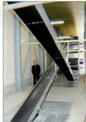
▲ Dans l'un des deux tunnels de séchage installés par Agromat, les tapis d'arrivée et de transfert des fientes vers le hangar de stockage.
