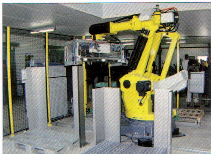
▲ Robot palettiseur Ovoconcept avec une prise automatique des palettes et intercalaires, pesée intégrée...
