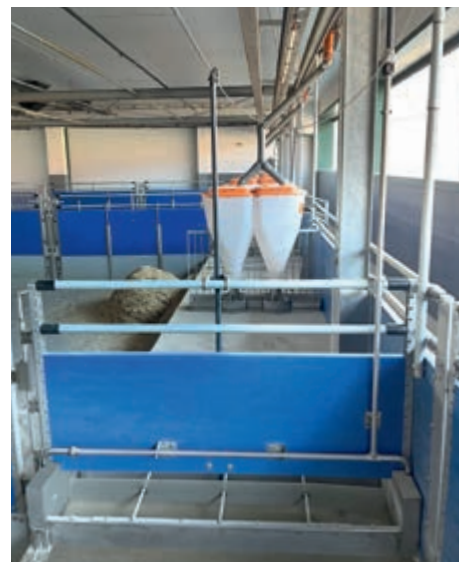
Специальная поилка для системы содержания с соломенной подстилкой Xaletto оснащена датчиком уровня наполнения. Это предотвращает ненужную потерю воды и соломенная подстилка остается сухой.
