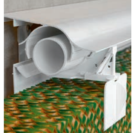
Верхний профиль и практичные крепления испарительных кассет позволяют производить быструю и простую замену кассет
