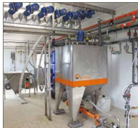
HydroAir – система жидкого кормления с точным дозированием корма для поросят
