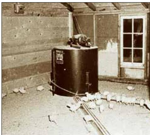
Автоматическая установка с транспортерной цепью с 1938 года
