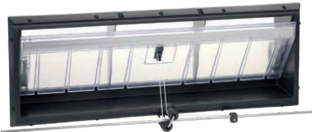
CL 1911 F прозрачный – данный фланцевый клапан был разработан в т.ч. для клиентов, которые заинтересованы в принятии участия в движении в пользу комфортного содержания животных на территории Германии. Светопроницаемая площадь окон должна составлять не менее 1,5% от основной поверхности секции. В данном случае можно отталкиваться от значения 0,14 м 2 светопроницаемой поверхности на клапан. В случае с клапаном CL 1200 данное значение составляет 0,086 м 2 светопроницаемой поверхности на клапан.
