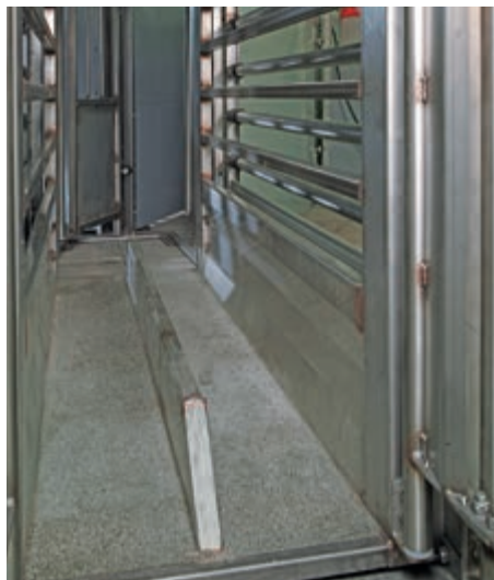
Waga jest wyposażona w antypoślizgową podłogę
