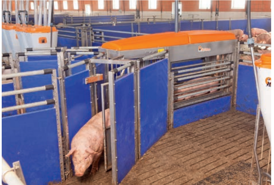
Zastosowanie wag TriSort pro z dwoma bramkami sortującymi
