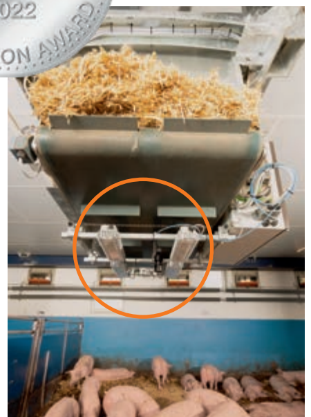
Capannone di finissaggio: il robot OlliGes riduce notevolmente il tempo richiesto per ripristinare la lettiera con paglia. Il robot scorre lungo dei binari per raggiungere qualsiasi luogo nel capannone.
