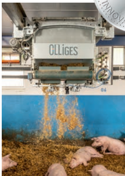
Capannone di finissaggio: il robot OlliGes riduce notevolmente il tempo richiesto per ripristinare la lettiera con paglia. Il robot scorre lungo dei binari per raggiungere qualsiasi luogo nel capannone.
