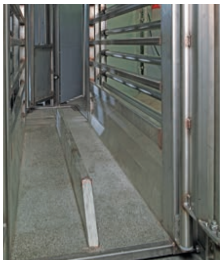
L'unità pesa è attrezzata con un pavimento anti-scivolo
