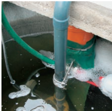
Upotreba potopne pumpe za opskrbljivanje CoolBox-a vodom
