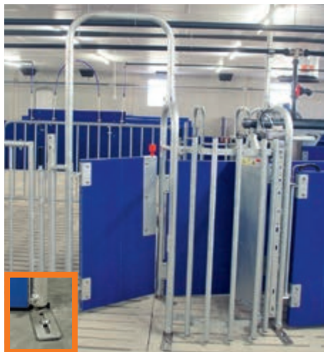
Provodni stup sa pivotirajućim vratima Učvršćenje u podlogu od nehrđajućeg čelika
