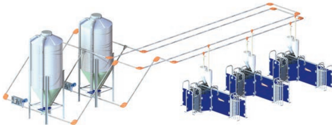
Funkcionalni dijagram CallMatic pro za suho hranjenje, upotreba dvije vrste hrane
