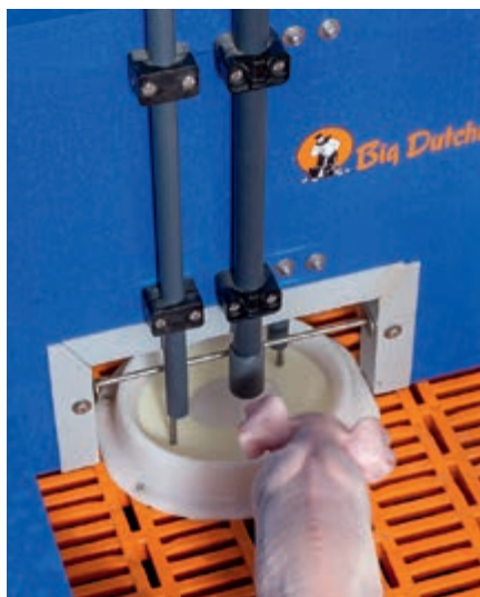
Senzor provjerava nivo u valovu i informira 510 pro računalo
