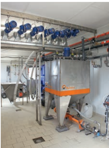
Configuration 1-cuve sans résidus à air comprimé
