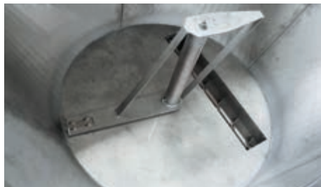
Au fond du réservoir se trouve une pale en Z et une vis de vidange
