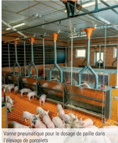
Vannes pneumatiques pour le dosage de paille dans l'engraissement
