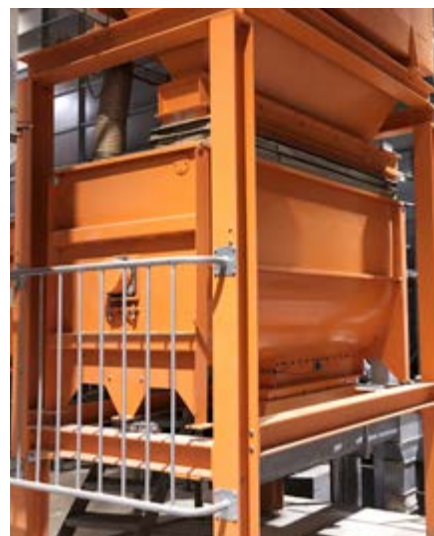
Un mélangeur horizontal avec trémie en amont
