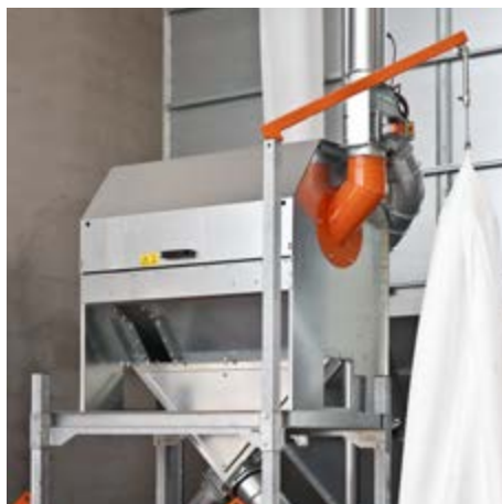
Nettoyeur tambour T1 monté dans un système de broyage
