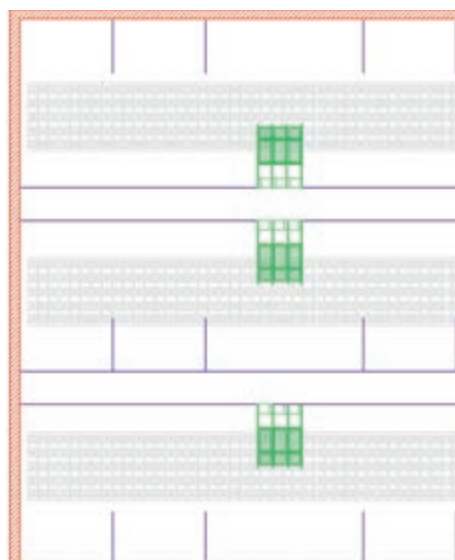
Conversion simple de stalles de caisse en CallBack pro . Souvent, l'approvisionnement en aliments peut encore être utilisé et il n'est pas nécessaire de modifier l'aménagement du sol.
