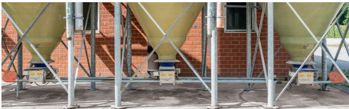
EcoMatic pro à 2 circuits d'aliment principaux
