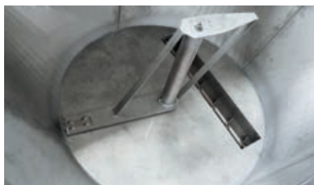
Suelo del recipiente con cuchillas en Z y rosca de extracción
