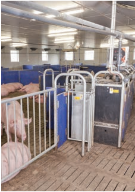
Sistema de alimentación a demanda CallMatic pro con HydroMix pro
