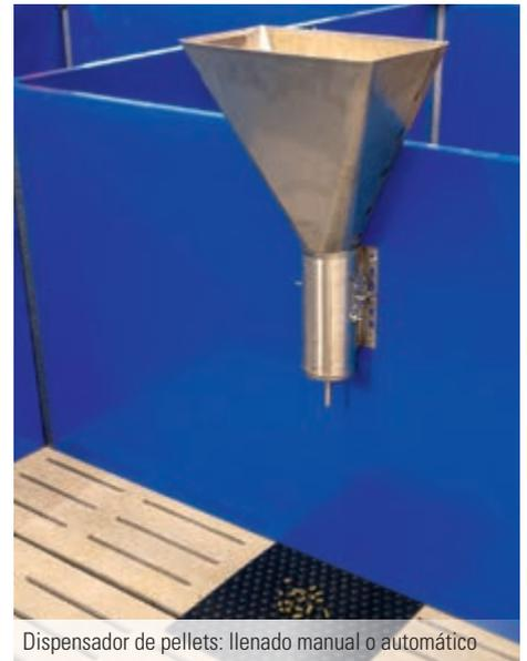
Dispensador de pellets: llenado manual o automático
