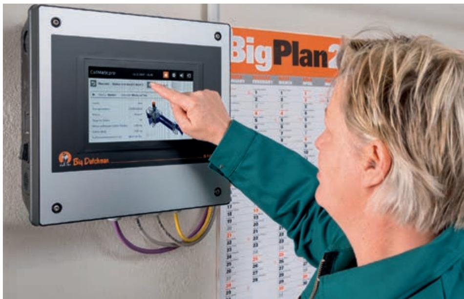
El ordenador de la estación puede manipularse cómodamente con la pantalla táctil de 10 pulgadas
