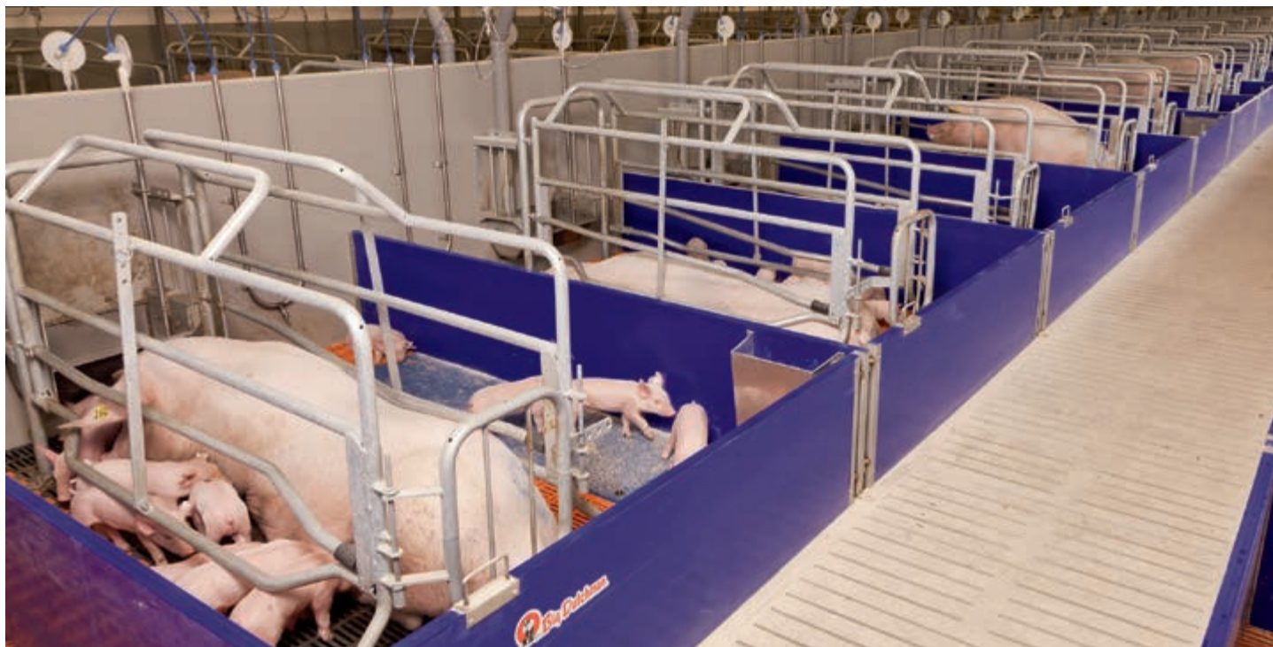
Corral con jaula de 4 pies con rejilla de fundición bajo la cerda und Heizplatte für die Ferkel
