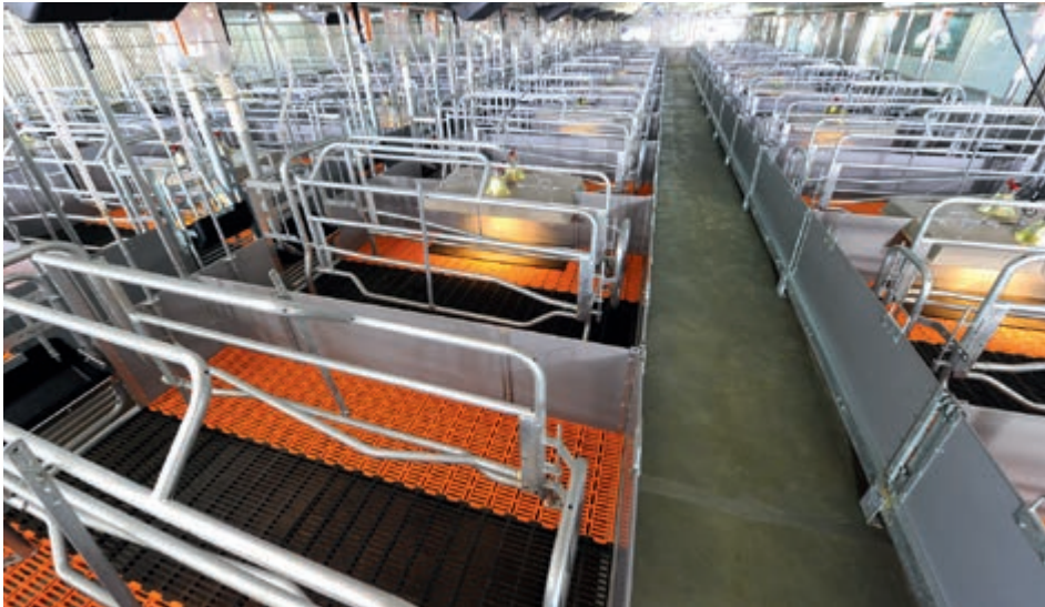
BD Swing con rejilla de fundición bajo la cerda y nido calefactable para lechones
