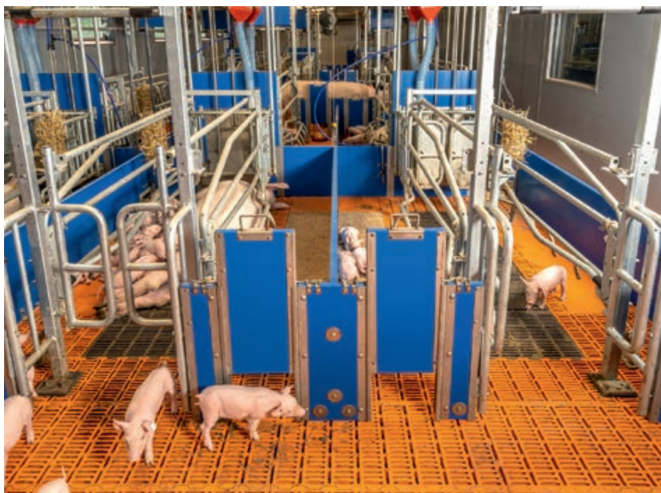
Agilo FB: la cerda decide si desea estar protegida en el bastidor salvalechones o en la zona común de movimiento
