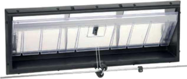
CL 1911 F transparente – hemos desarrollado esta entrada de aire con brida para, entre otros, clientes que desean participar en la iniciativa alemana para el bienestar animal. La superficie transparente de la ventana debe abarcar al menos el 1,5 % de la superficie del suelo de una sala. En este caso se puede calcular 0,14 m 2 de superficie transparente por entrada de aire. En el caso de CL 1200, este valor es de 0,086 m 2 de superficie transparente por entrada de aire.
