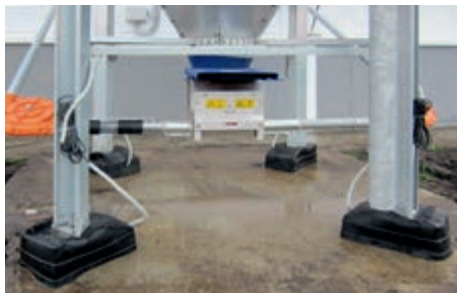
Cubierta de pata de silo para un pesaje seguro, incluso en condiciones climáticas extremas
