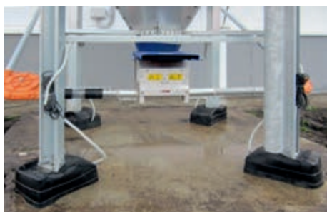
Silo fodbetræk til sikker vejning selv under ekstreme vejforhold
