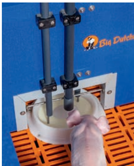
Niveausensor overvåger fyldning af mælketrug
