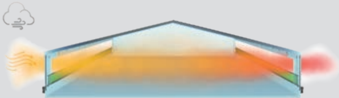
Natürliche Ventilation in Ställen bis maximal 15 m Breite
