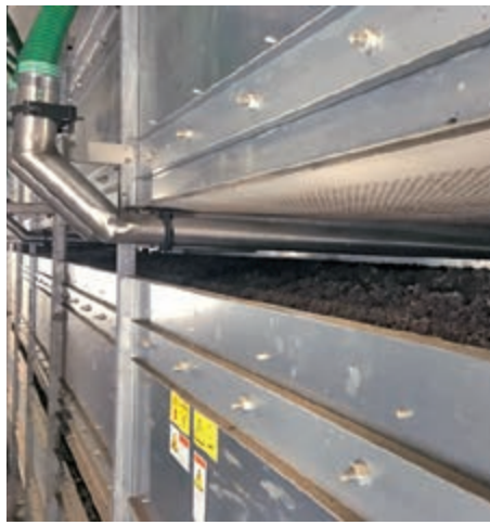
Über ein Verteilsystem wird die flüssige Phase gleichmäßig auf das zu trocknende Material aufgebracht
