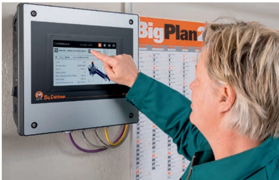
Der Stationscomputer lässt sich über das 10-Zoll-Touchdisplay komfortabel bedienen
