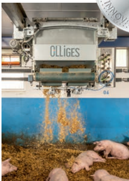
Stáj výkrmu: Použití robota na slámu OlliGes výrazně zkracuje dobu práce potřebnou k dostýlání slámy. Robot se pohybuje po kolejnicovém systému, aby se dostal na libovolné místo ve stáji.
