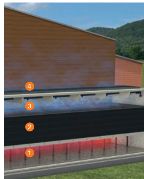
Odsávaný vzduch stoupající skrze balík filtrů
