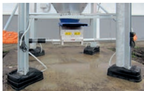
Защитни обувки на силоса за точно претегляне дори и при екстремни климатични условия
