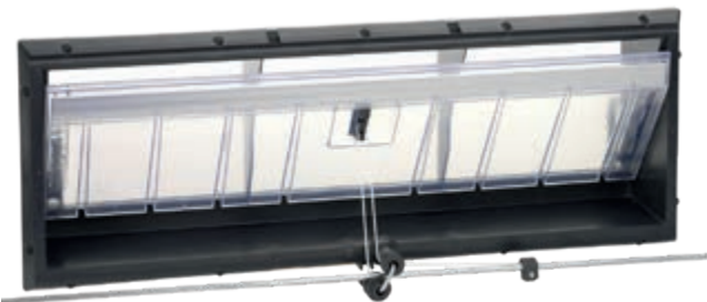
CL 1911 F прозрачна – между другото ние разработихме тази клапа с фланец за клиенти, които искат да участват в инициативата за комфорт и природосъобразно отглеждане на животните. Светлопропускливата площ на всички прозорци трябва да обхваща мин. 1,5 % от застроената площ на помещението. При това положение светлата част е в размер на 0,14 м 2 /клапа. При клапите CL1200 тази стойност е по-ниска и възлиза на 0,086 м 2 /клапа.
