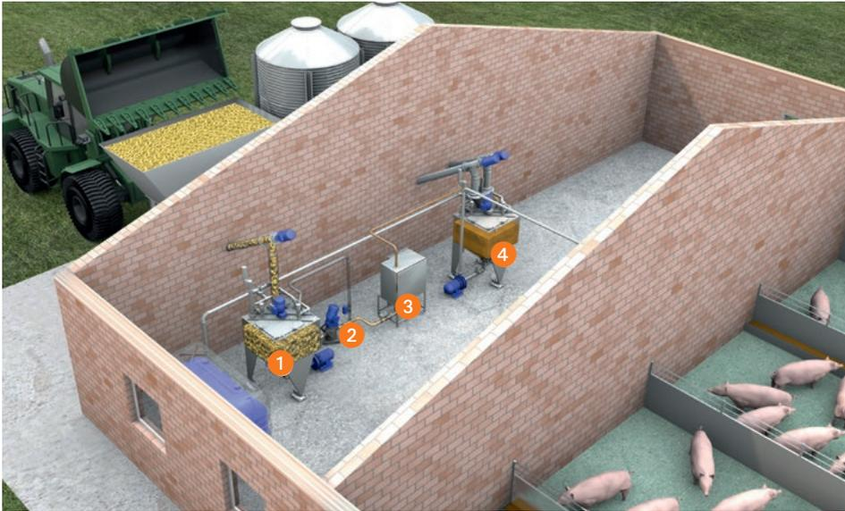
**PEF** steht für **Pulsierende Elektrische Felder**. Das bedeutet, die gehäkelte Maispflanze wird Hochspannungs-Impulsen ausgesetzt und dadurch verdaulich gemacht.
