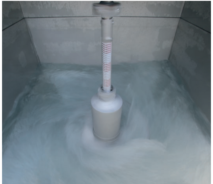
Niveaureguliertes Rührwerk bei hohem und bei niedrigem Füllstand im Anmischbehälter: Ein Schwimmer gewährleistet in Abhängigkeit vom Füllstand, dass das Rührwerk in die optimale Rührposition gebracht wird.
