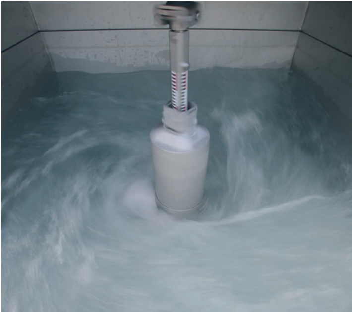
Niveaureguliertes Rührwerk bei hohem und bei niedrigem Füllstand im Anmischbehälter: Ein Schwimmer gewährleistet in Abhängigkeit vom Füllstand, dass das Rührwerk in die optimale Rührposition gebracht wird.
