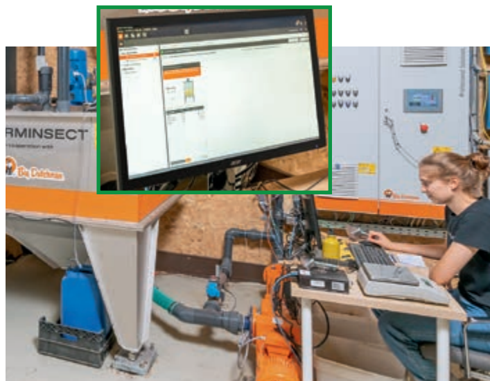
Wymieszanie pulpy paszowej następuje w dwóch mieszalnikach w sterowanym komputerowo procesie, dlatego oba mieszalniki stoją na czujnikach wagowych
