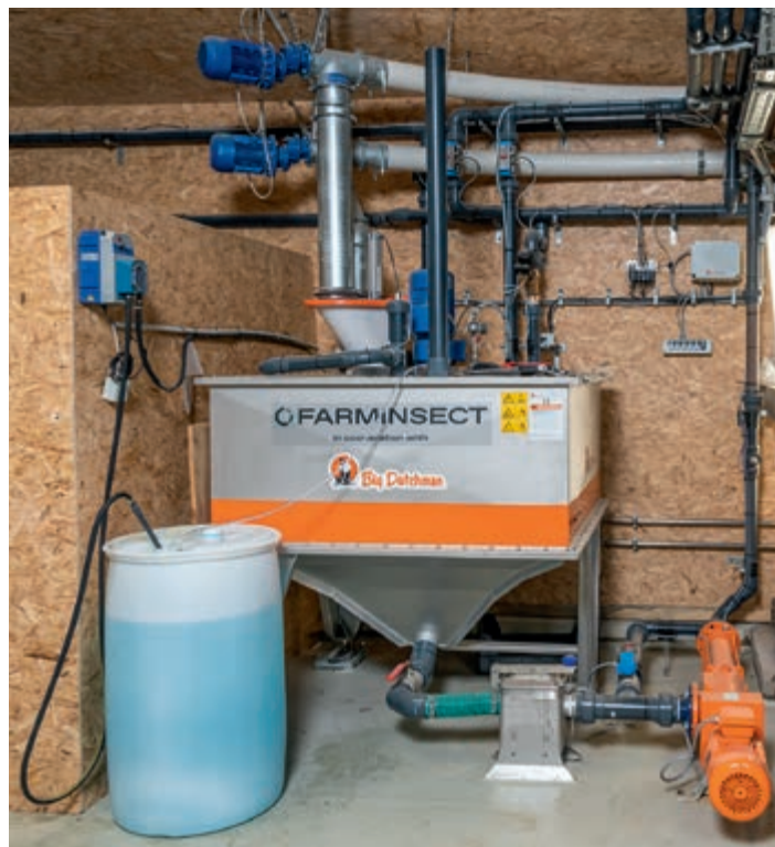
Wymieszanie pulpy paszowej następuje w dwóch mieszalnikach w sterowanym komputerowo procesie, dlatego oba mieszalniki stoją na czujnikach wagowych
