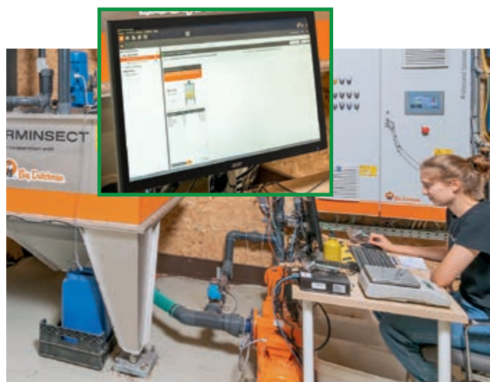
Le mélange de la pâte d'aliments est commandé par ordinateur et s'effectue dans deux cuves. Pour ce faire, les deux cuves de mélange se trouvent sur des cellules de pesage
