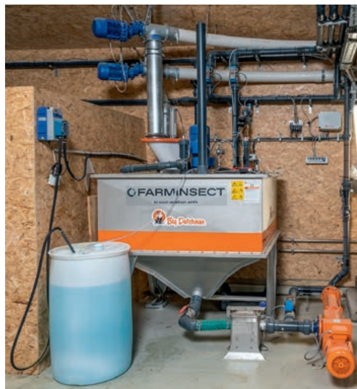
Le mélange de la pâte d'aliments est commandé par ordinateur et s'effectue dans deux cuves. Pour ce faire, les deux cuves de mélange se trouvent sur des cellules de pesage
