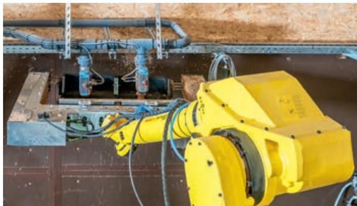
A través de las dos válvulas de alimentación se dosifica el alimento fresco para el engorde de una semana
