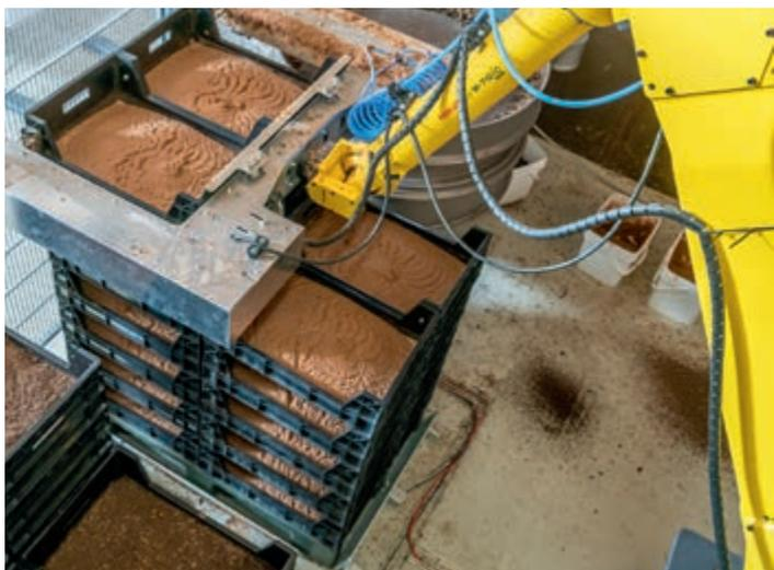
El brazo robótico apila las cajas, recién rellenas de mezcla alimenticia, sobre un palé, ...
