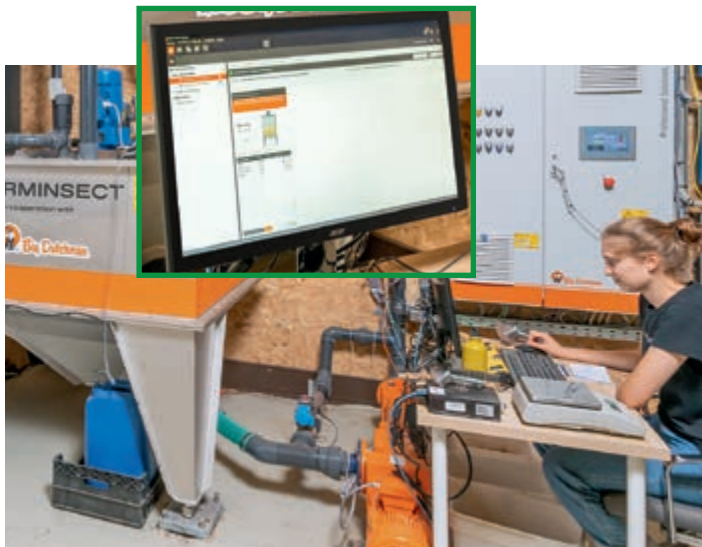
Das Anmischen des Futterbreis erfolgt computergesteuert in zwei Mischtanks. Dazu stehen beide Mischtanks auf Wiegezellen
