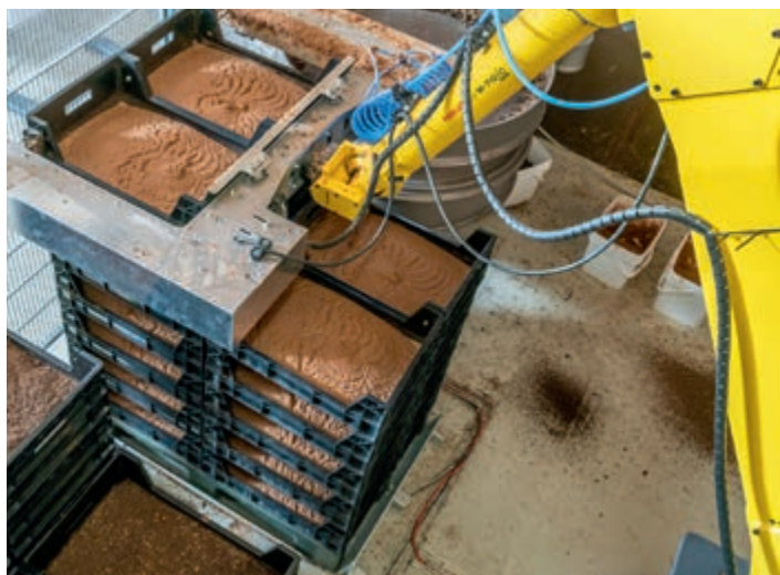
Der Roboter stapelt die frisch mit Futterbrei gefüllten Kisten auf einer Palette, ...
