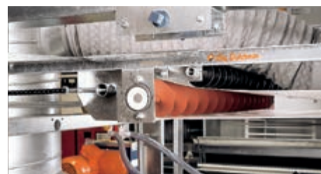
Поворотный узел ленты пометоудаления с очистительным шнеком (опция) для очистки ленты ПУ от перьев и пыли (на возврате ленты)
