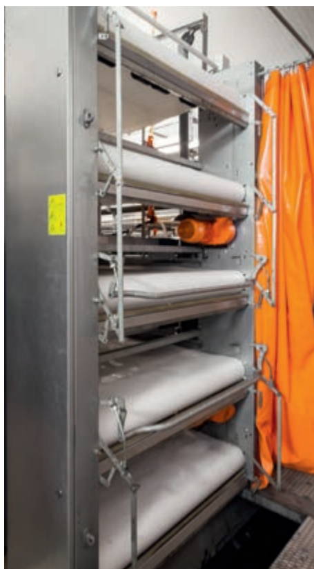
Лента пометоудаления со скребками и системой центрального регулирования
