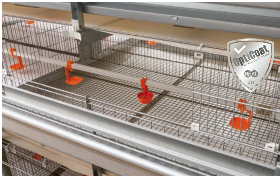
Ярус для цыплят серии UV-S 680 с чашей открытого типа для упрощения доступа птицы к воде в первые дни жизни (опция)
