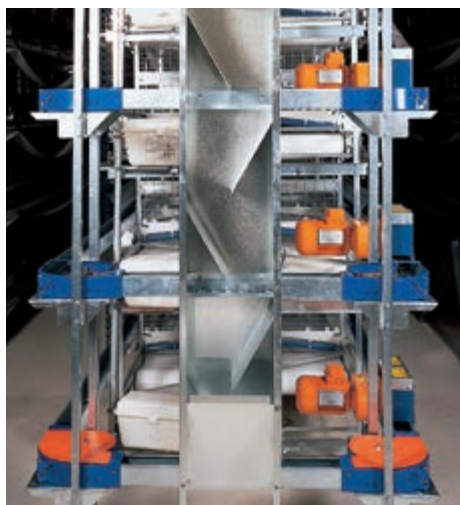
Каскадная форма кормоколонки предотвращает склеивание корма
