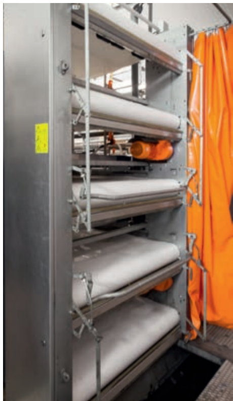
Лента пометоудаления со скребками и системой центрального регулирования
