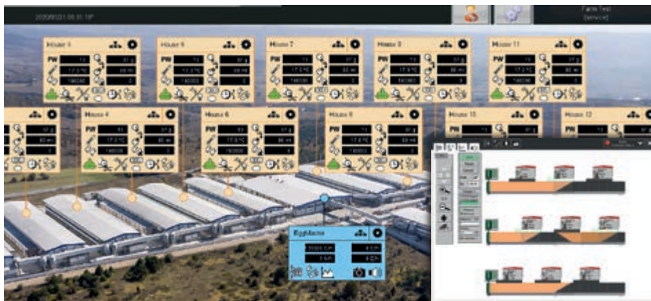
Полный обзор и управление через сенсорный дисплей в шкафу управления
