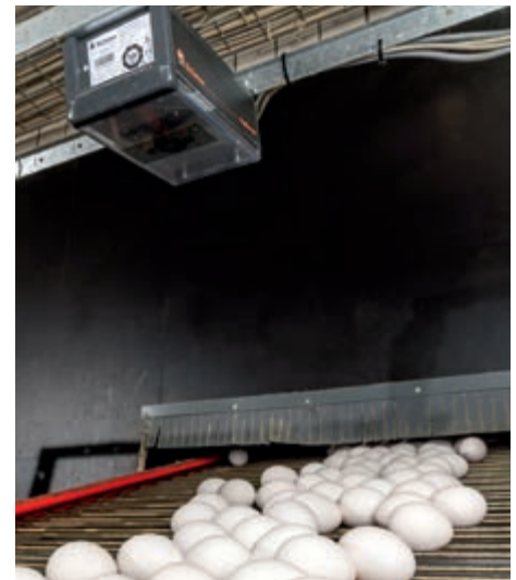
EggCam 3D на поперечной ленте яйцесбора
