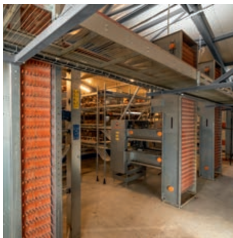
Элеватор ЕС с интегрированной функцией сбора системного яйца
