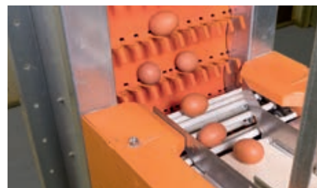
Передача яйца на очень короткий прутковый транспортер
