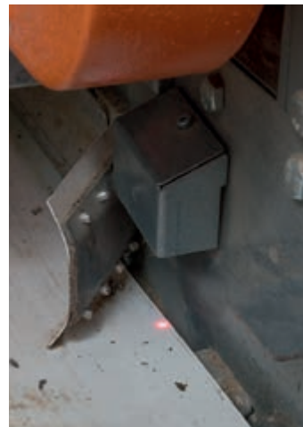
Световой датчик для мониторинга ровного хода ленты ПУ
